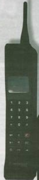
Motorola, International 3200 Kam 1992 als erstes Handy in Deutschland auf den Markt, kostete etwa 3000 Mark. Man konnte damit telefonieren, mehr nicht.
